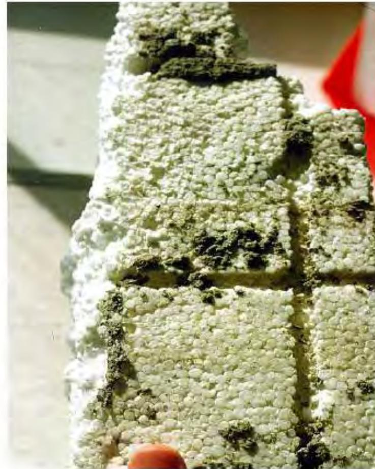
**WDVS: Schichttrennung ist möglich**
