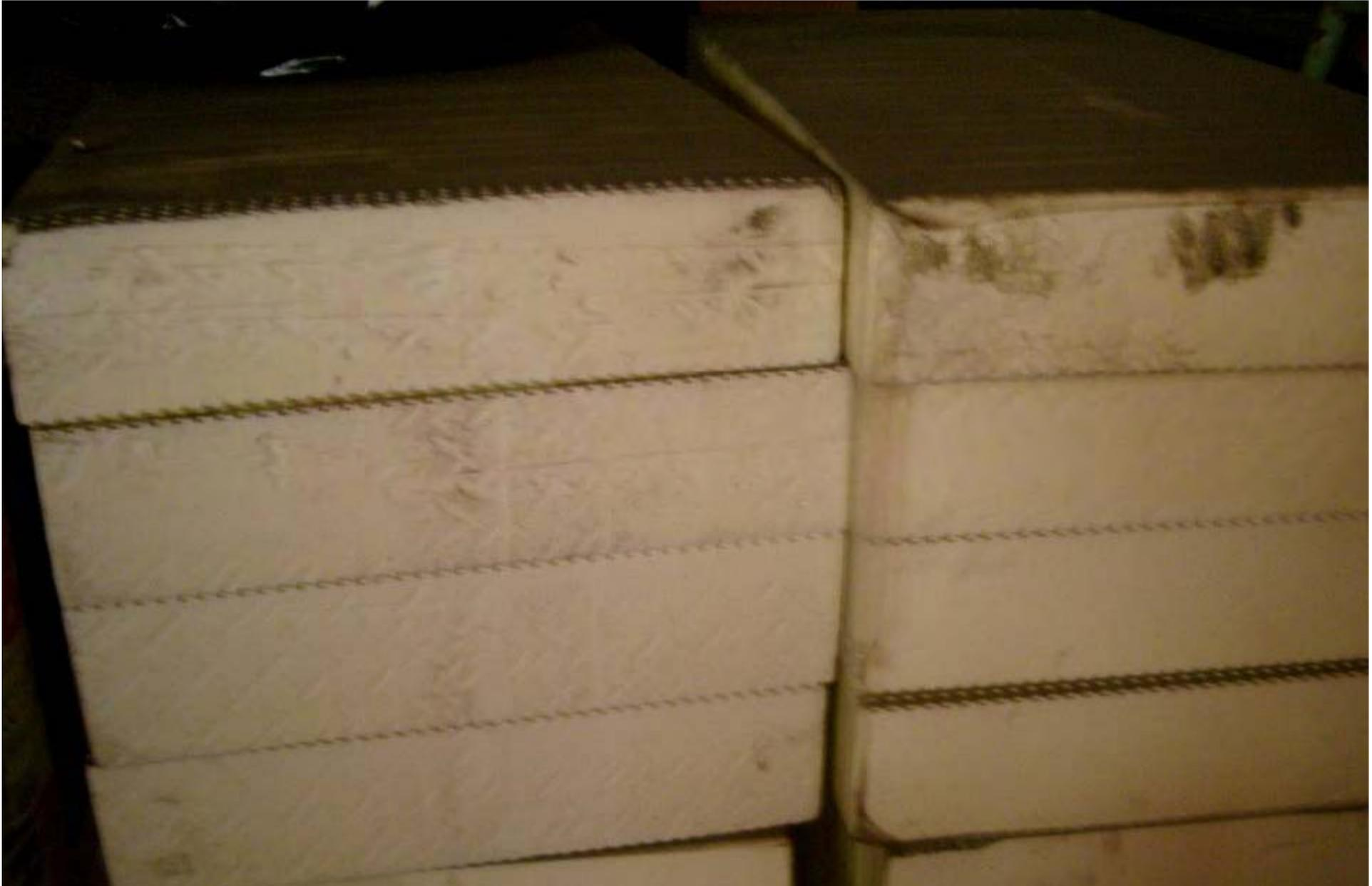
■ Zellulosedämmplatten = 0,04-0,045 W/(mK)
